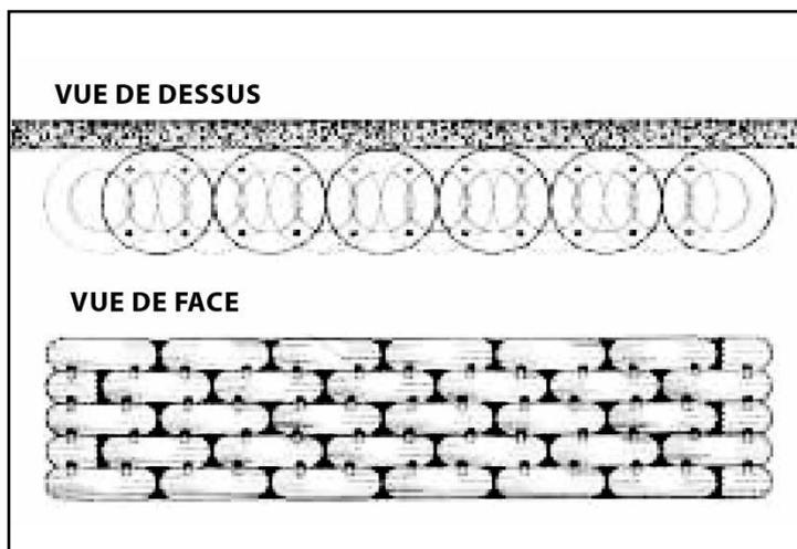
La fixation de ces piles de pneus d'automobile pourra être faite par feuil lard en plastique ou tout matériau équivalent.
