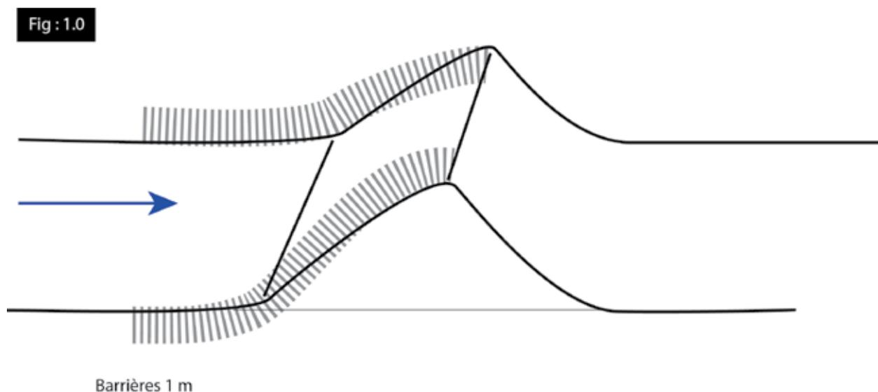
A titre d'exemple, si une bosse mesure 8 mètres large à sa base, il convient de réduire la largeur de celle-ci à son sommet à 6 mètres environ.
